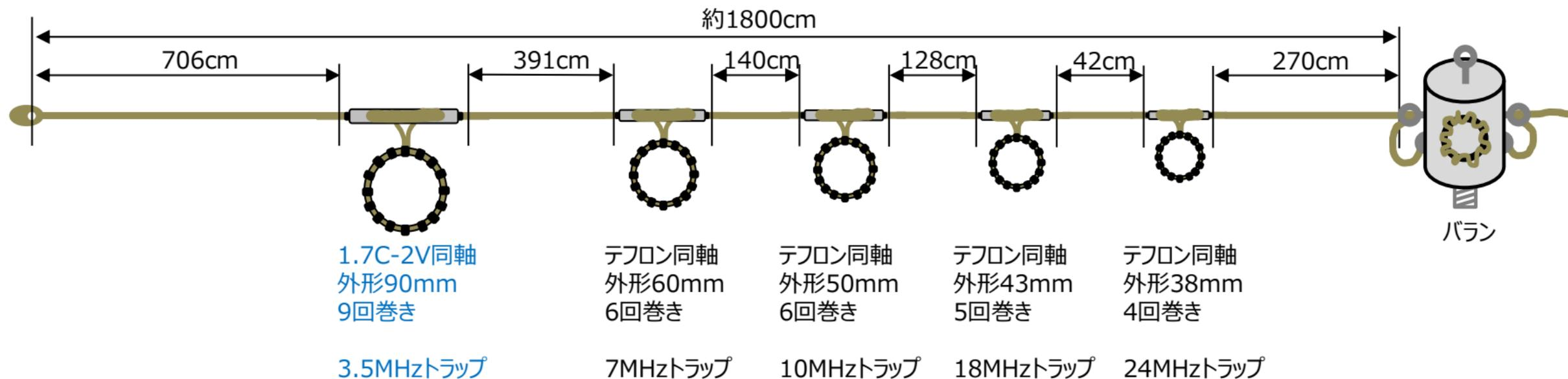
自作3.5MHzトラップを付け、1.9/3.5/7/10/18/24MHzの6バンドトラップダイポール化した
